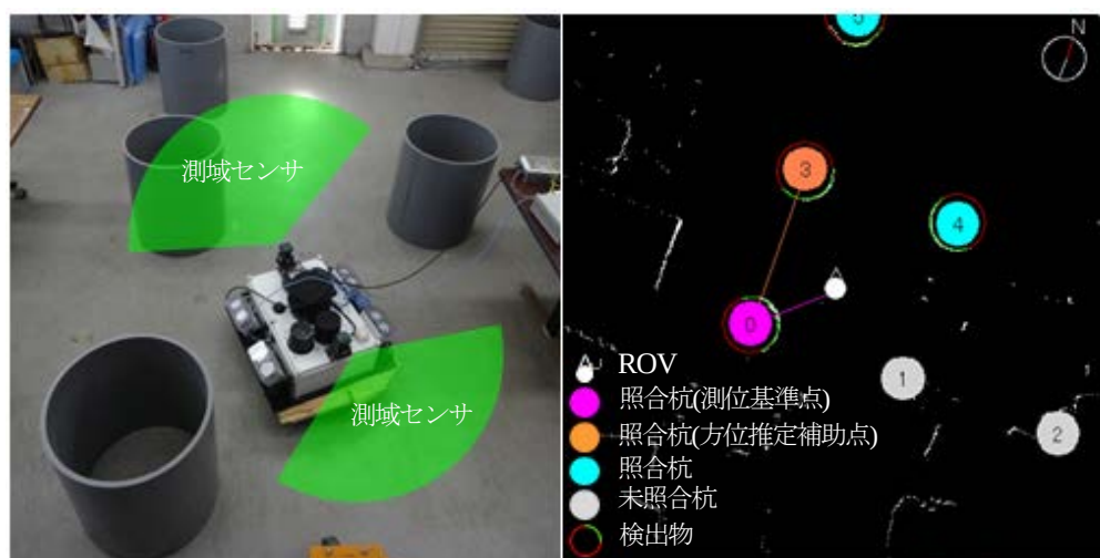
図-4 レーザー測域センサによる周囲走査結果と施設情報の照合による自機位置推定技術
