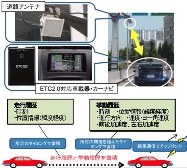
図-4 ETC2.0 プローブデータの収集
