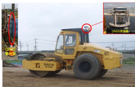
写真-4 「TS・GNSSによる締固め管理技術」を用いた転圧機械
