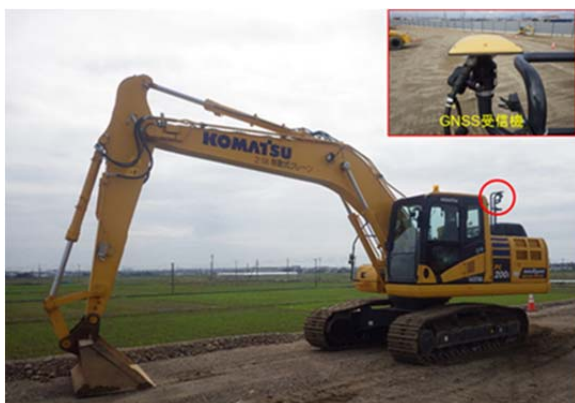
写真-3 マシンコントロールバックホウ
