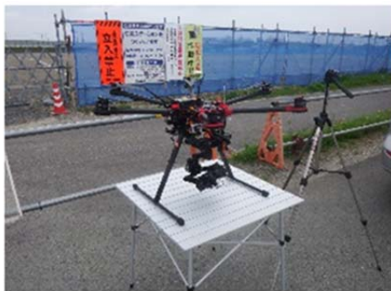
写真-1 使用したUAV機器 (DJI S900)
