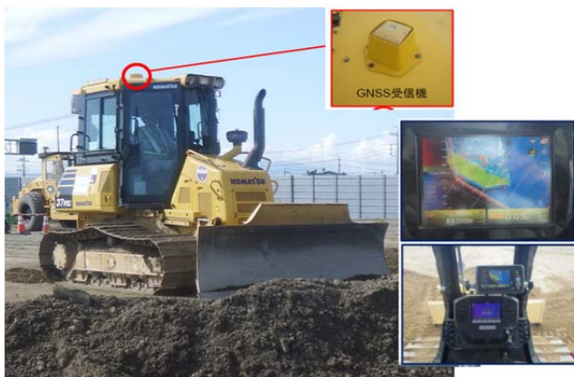
写真-2 マシンコントロールブルドーザ
