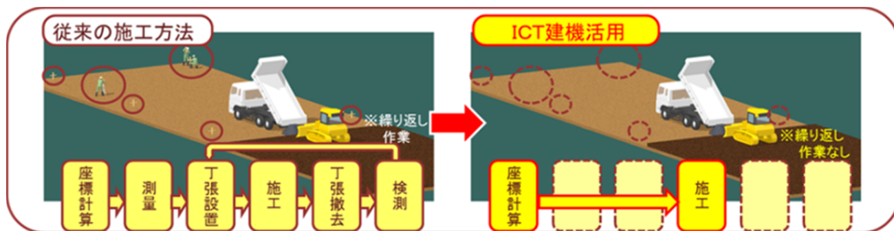
図-5 従来とICT建機を活用した場合との施工イメージ
