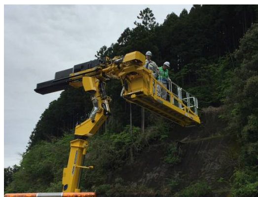
図-22 橋梁点検車の高所作業利用イメージ
