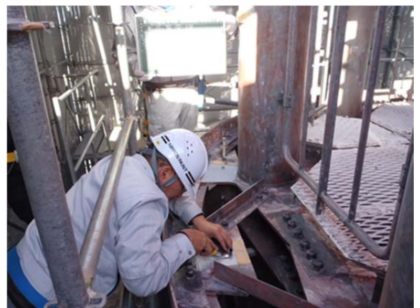
写真-3 基盤目試験調査状況写真
