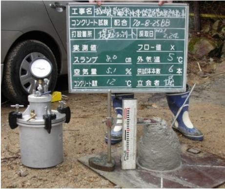
中津川出張所管内では過去に小規模な維持補修で使用した実績(経年観察は未実施)があるので、その最新製品である電気化学工業(株)製のエトリンガイト系高強度混和材Σ-80N(NETIS KT-110075-A:2012/01/31 登録)を用い圧縮強度 70N/mm<sup>2</sup>超の高強度コンクリートを試用した。
