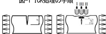
図-2 表面き裂をICR処理によって内部き裂とみなす概念図
