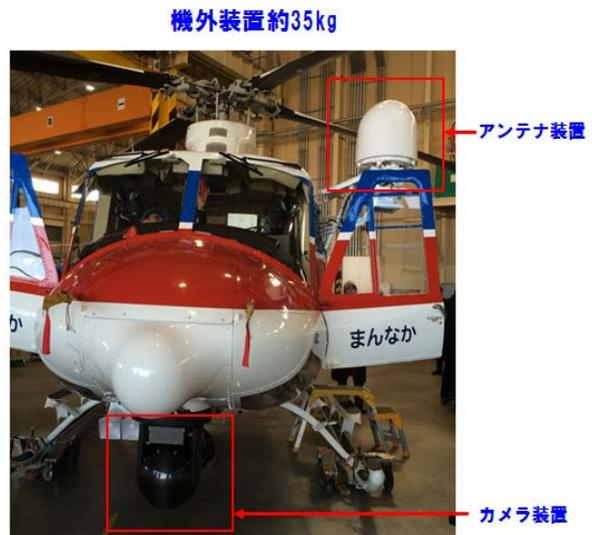
図-4 ヘリサットシステム機外設備
