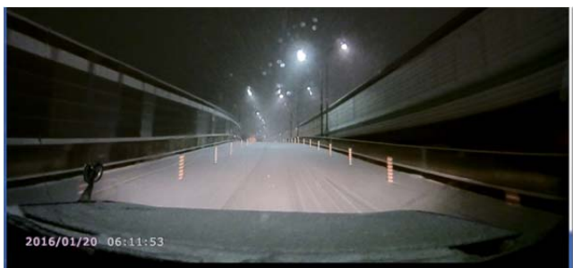
図-11 塩水散布 1 時間20分後 (H28.1.20 6:11) 国道23号築地口オンランプ
