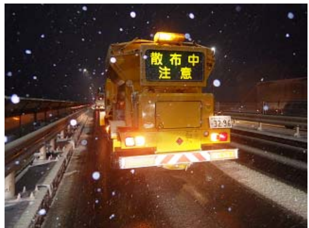
図-2 薬剤散布車による薬剤散布状況
