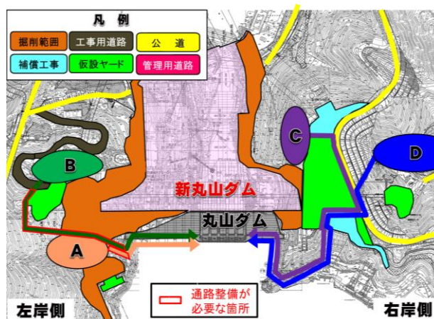
図-3-4 丸山ダムへの連絡経路（工事中）
