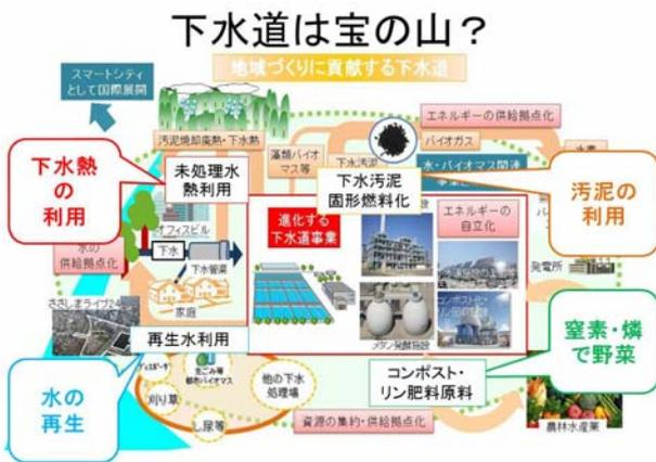
図-3 下水道のエネルギー利用
