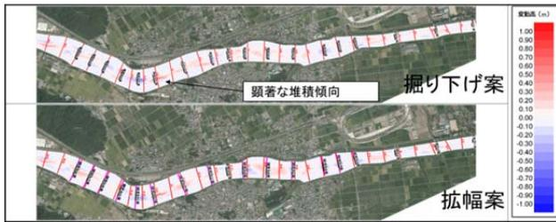
図-9 河床変動計算平面図 (CASE2)
