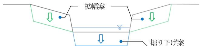
図-2 掘削形状のイメージ
