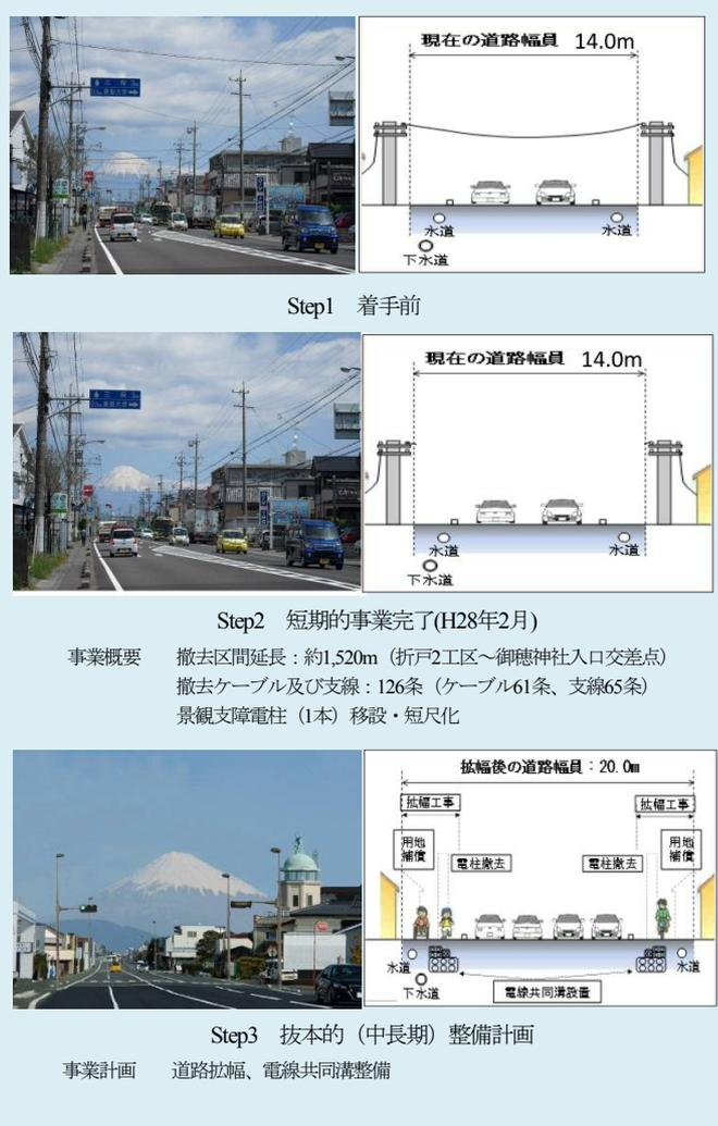
図-7 県道三保駒越線（通称：三保街道）無電柱化計画の概要
