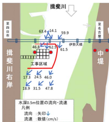
図-9 汚濁防止膜付近の流況測定結果（揖斐川）
