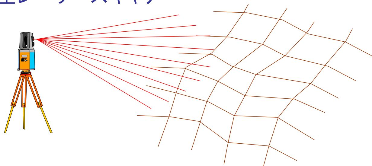
レーザー光線を1秒に何万回も角度を変えつつ発射し、その反射から測定物の形状を測定します。同時に写真も撮影し3次元での表現が可能となります。データとしてはX, Y, Zの点データの集まり(点群データ)となります。
