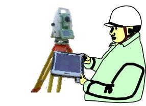
工事進捗に合わせて出来形を測定、社内の基準に基づく頻度、箇所で品質証明員による測定も行う。
