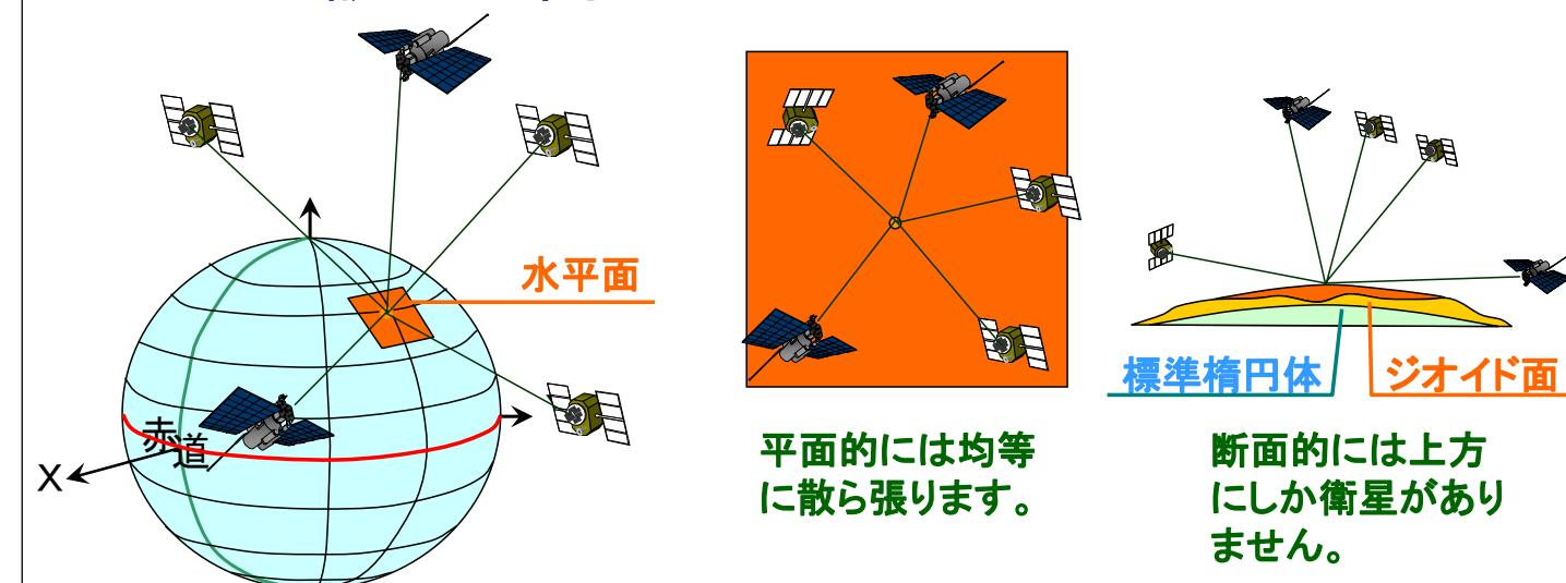
GNSSの誤差は、衛星の配置によって左右されます。観測面に対し衛星が散らばる水平誤差の方が、上方に集中する鉛直誤差より精度が高く誤差は小さくなります。また、標高はジオイド面からの高さで表されますが、GNSSでは標準楕円体からの高さとなり補正の仕方によっては誤差がより大きくなります。
