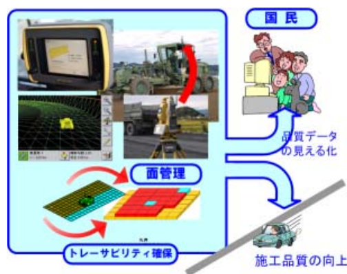
図 2.9 施工管理データを活用した施工品質の「見える化」のイメージ
