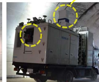
レーザーレーダーを搭載しひび割れ、漏水等の変状を計測する。
