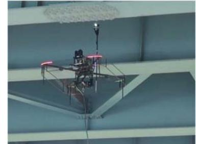
現場検証に使用する飛行ロボット
