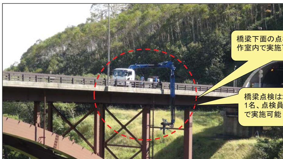
橋梁下面の点検作業は操作室内で実施可能
