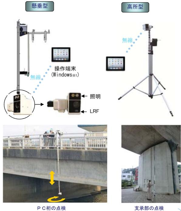
橋梁等構造物の点検ロボットカメラ
