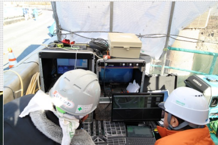
放流設備の点検：画像鮮明化技術により鮮明化された画像を確認
