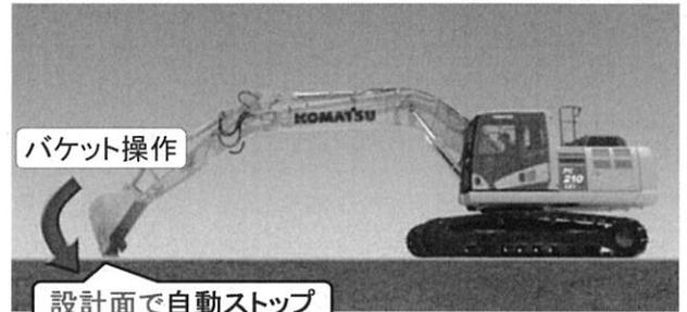
ブーム・バケット操作の時、バケット刃先が設計面に達すると作業機が自動停止。
