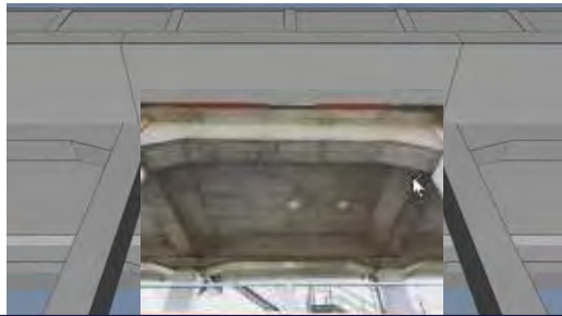
3次元CADモデル上で生写真の重畳配置
