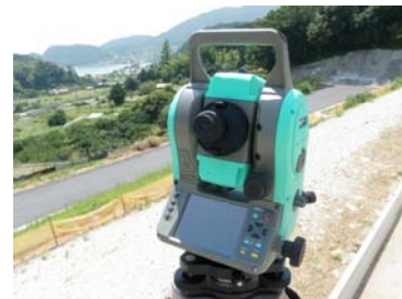
写真-11 TS出来形測定機器Nivo(ニコントリブル)
