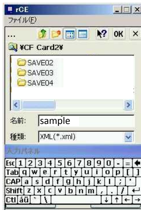
図-14 施工管理データの書出し機能（例）
