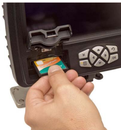
写真－10 MC・MG技術への3次元設計データの搭載方法
