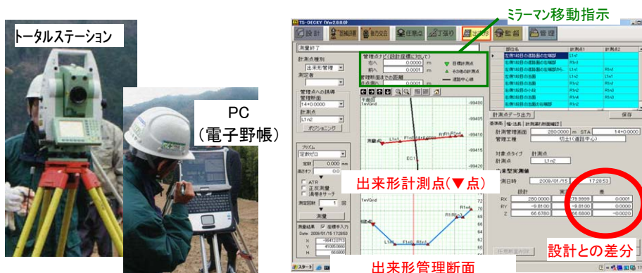
写真-11 出来形管理用TS
