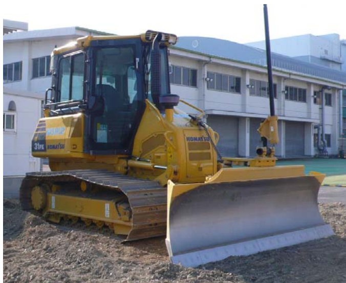
写真-2 MG技術を搭載したブルドーザ
