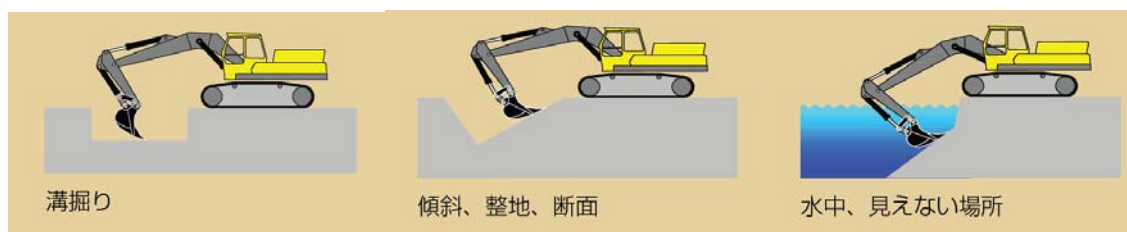
図-3 2Dバックホウ適用範囲（例）
