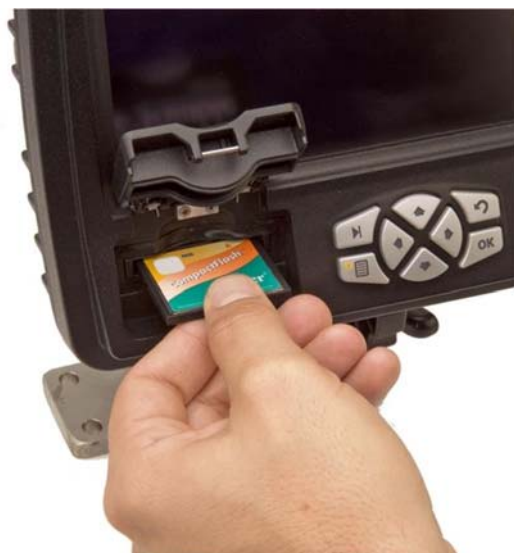
写真－9 マシンガイダンス技術への3次元設計データの搭載方法
