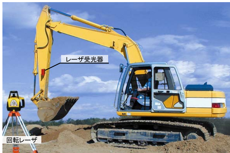
図-6 2Dバックホウの機器構成例 (上：標準 (N社)、下：回転レーザー使用時 (L社))
