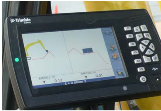
写真-3 ICTバックホウのモニタ表示（例） （左：3Dバックホウ（N社）、右：2Dバックホウ（N社））
