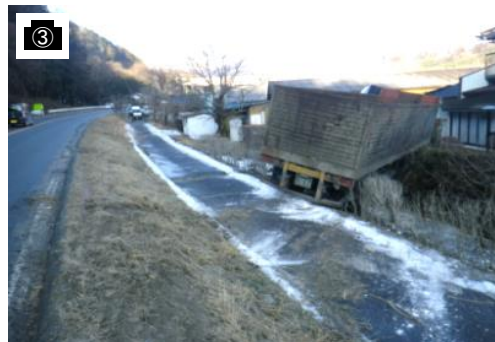
路面凍結によるスリップ事故
