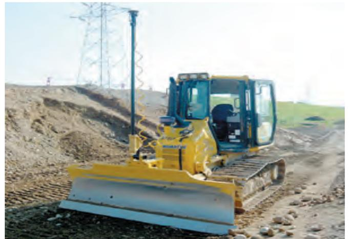
☆3D マシコントロールシステムブルドーザー
