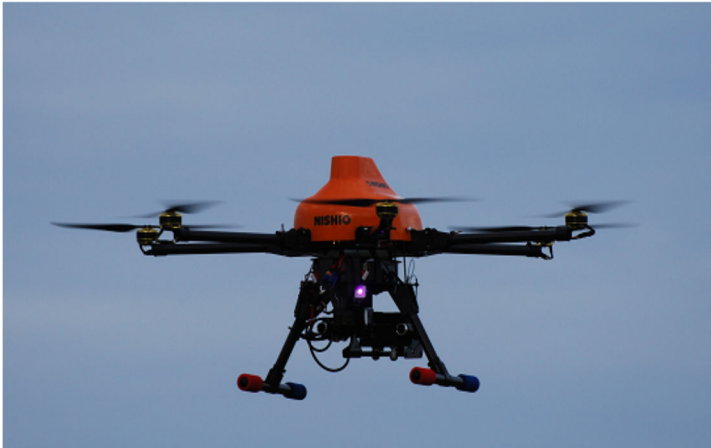
☆UAV マルチコプター自動航行 3次元測量システム
