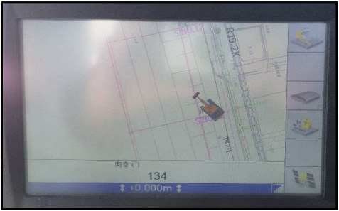
車載PCに搭載された設計データに対する施工機械位置を表示
