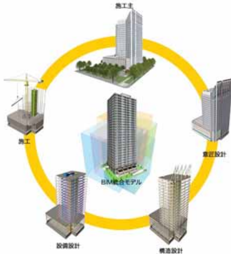
BIMのイメージ図 (複数の企業でデータを共有・統合する)
