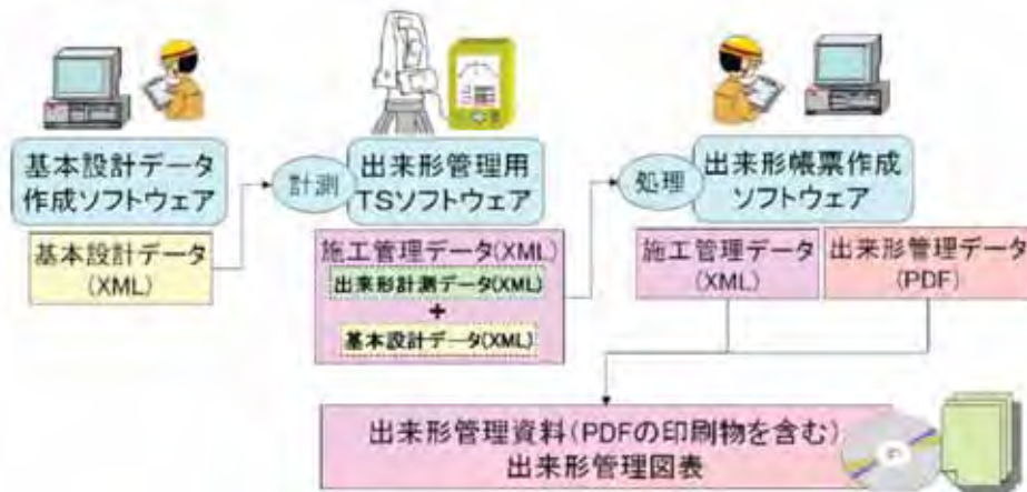
TSを用いた出来形管理の流れ
