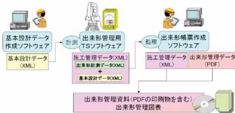
TSを用いた出来形管理の流れ
