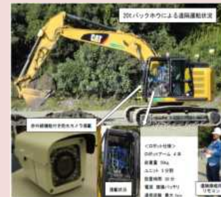
▲災害応急復旧ロボット (無人化施工)
