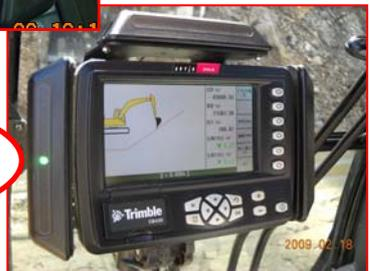
マシンガイダンス技術の採用により、建設機械の作業効率は格段に向上します。
