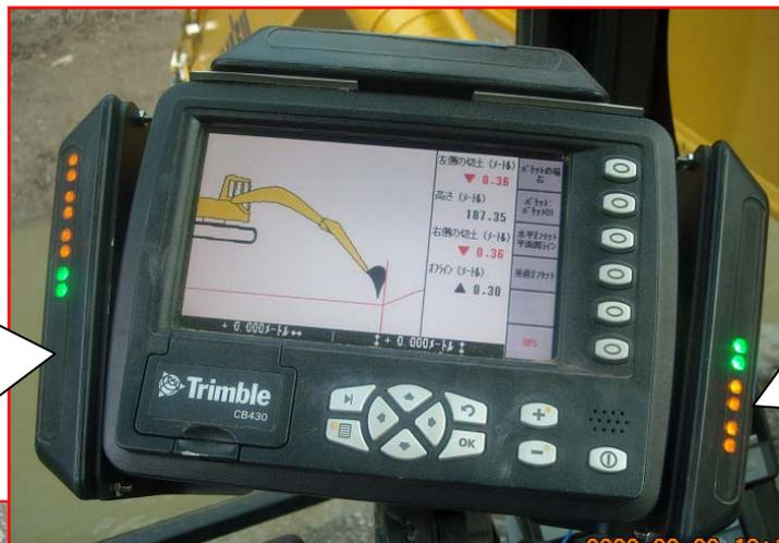
「前後方向」「左右方向」「高さ」それぞれの設計面に対する差分を3つのライトバーで表示します。
