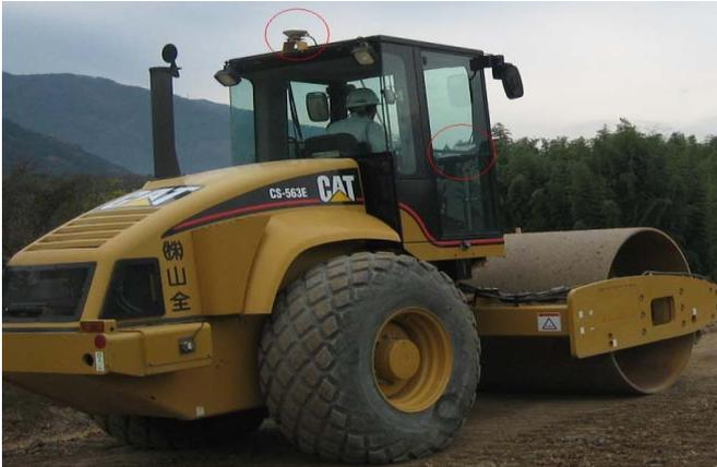
サイトコンパクターは、GPSやTSを用いて確実な締固めをサポートするソフトウェアです。座標情報をもとにした「面」の管理によって、施工品質の向上・コストの削減を実現します。
