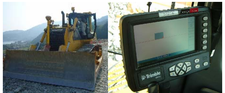
写真-3 MG ブルドーザ（左）、コントロールボックス（右）
