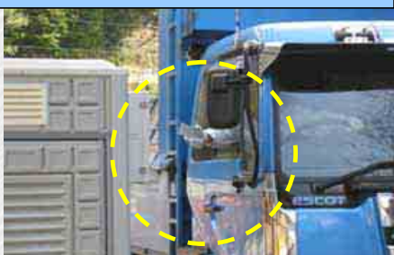
① アンテナにICタグをかざして車両を識別
