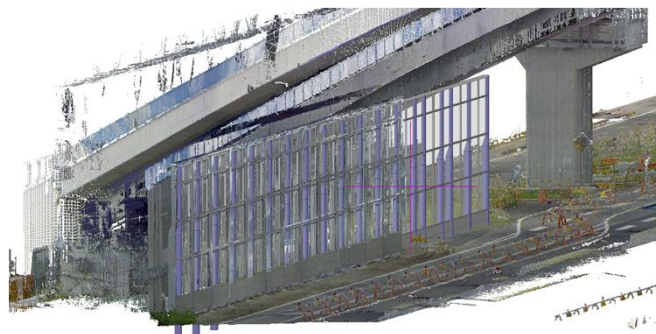
3Dモデルと点群データの合成イメージ
