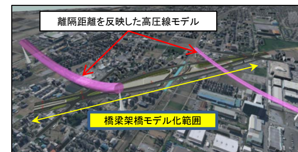
橋梁と架空線の離隔確認
