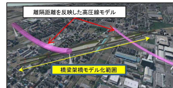
橋梁と架空線の離隔確認
