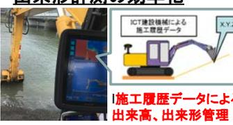
ICT建設機械による施工履歴データ
