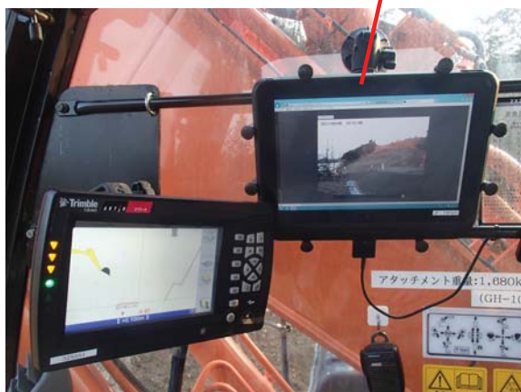
オペレーターも固定カメラの映像確認して作業
