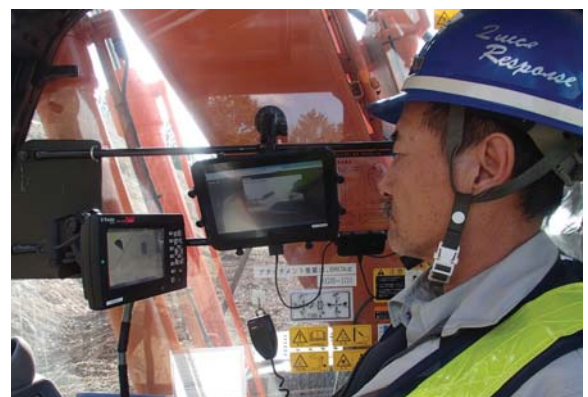
オペレーターも固定カメラの映像確認して作業
