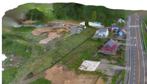
現地での測量開始から、点群データ完成までの所要時間：約6時間
