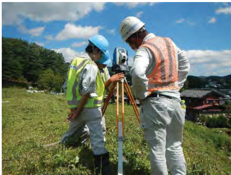
UAVでの撮影後、標定点を測量
