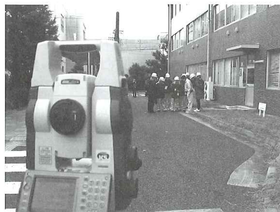
トータルステーションを使った測量の体験実習。現地測量から出来形管理までの一連の流れを体験する
