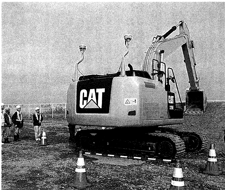
バックホウに取り付けられたGNSS受信機
