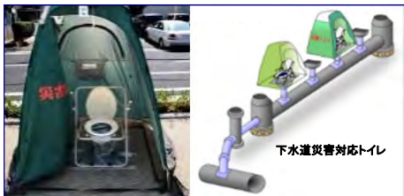
● 防災用マンホールトイレの整備 (岡崎市)
