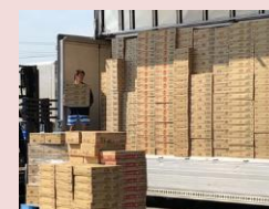
バラ積み・バラ降ろしによる非効率な荷役作業
