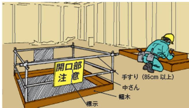
開口部周りの墜落防止措置の例
