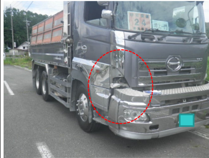
10 t ダンプトラック損傷箇所
