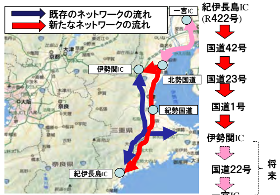
◇国道の伝送路を活用した光ネットワークのダブルネット化
