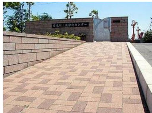
(参考)写真11 下水汚泥焼却灰を混ぜて作った歩道用ブロック
