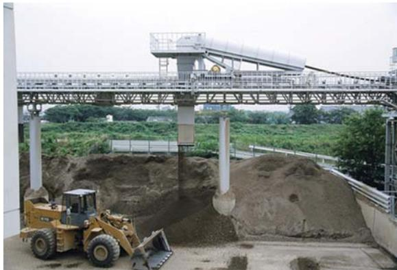
名古屋市の「鳴海改良土センター」では、下水道工事で発生する掘削土に土質改良材として汚泥焼却灰を混ぜ、良好な埋め戻し土を製造している。
