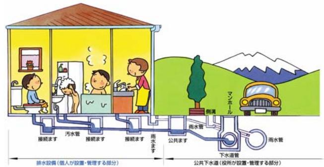
分流式下水道のしくみ
